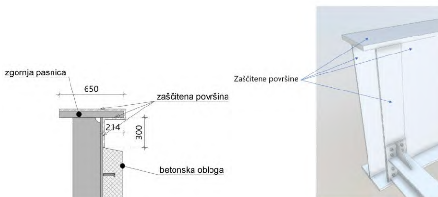
Slika 6: Deli izpostavljenih jeklenih površin, ki so zaščiteni predvsem proti odtekanju rje, in deli, ki so zaščiteni predvsem proti odtekanju rje pri podpori
